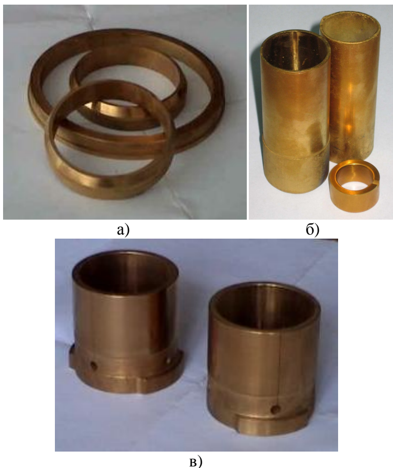
Рис. 1. Варианты изделий с покрытиями на ВЦП изделий: а – направляющие кольца насосов, б – втулки подшипников скольжения, в – полумуфты прокатного стана
