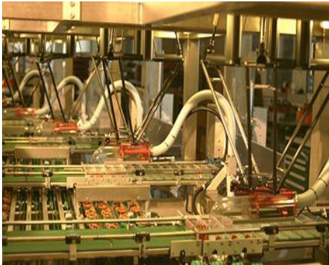
Рис. 1. Автоматична лінія для упаковки кондитерських виробів
