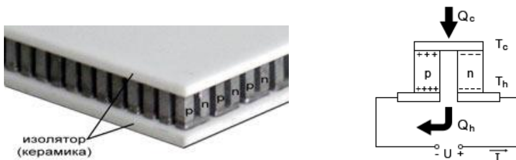
Рис. 1. Общий вид и схема генераторного термоэлектрического модуля
