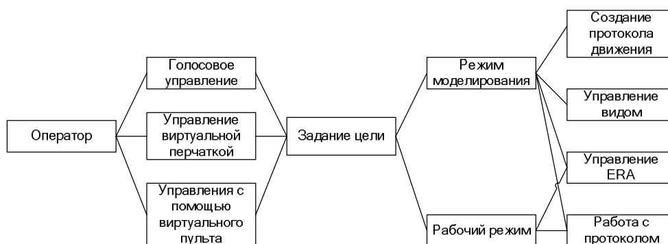
Рис. 1. Функциональная схема взаимодействия оператора с системой
