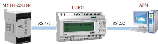
Рис. 3. Структурная схема автоматизации стенда
